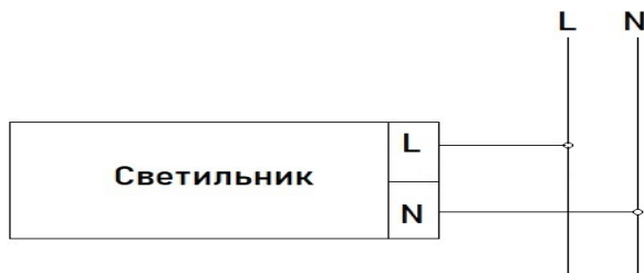
Рис. 2. Схема подключения к сети
