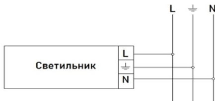
Рис. 2. Схема подключения к сети
